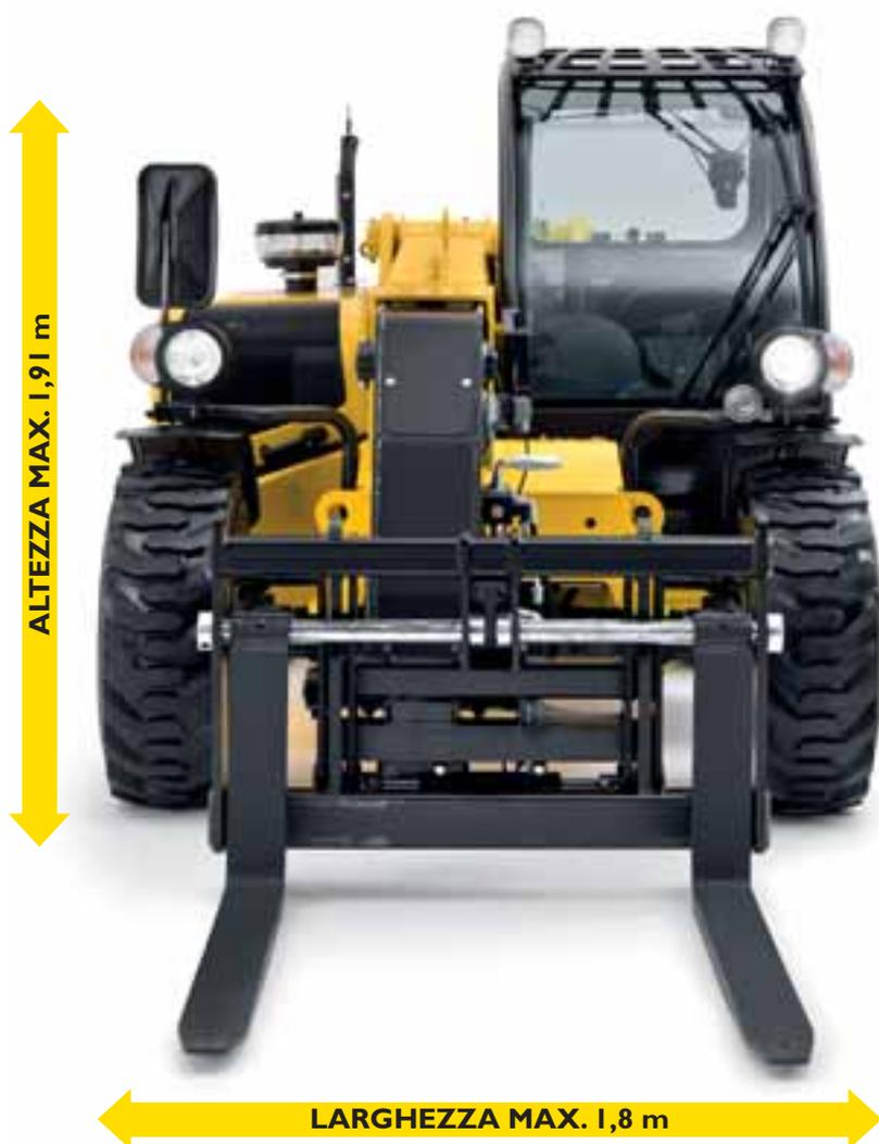
Le 4 ruote sterzanti del modello LM625 consentono di selezionare 3 diverse modalità di sterzata mediante un selettore che impedisce l'inserimento di impostazioni errate, ed è ergonomicamente posizionato in cabina dietro il joystick. Potete così selezionare la modalità di sterzata più idonea al tipo di lavoro da svolgere.
