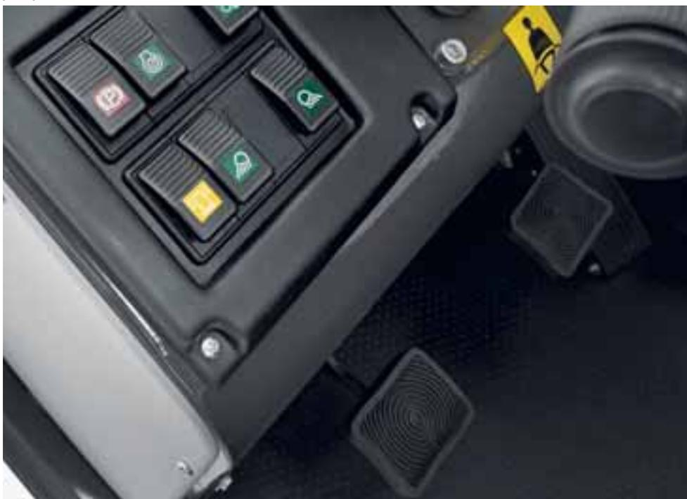
*Con il pedale di accostamento, l'operatore può modulare la potente trasmissione idrostatica*
